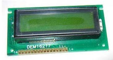
Gambar 8. LCD 2X16 digit
